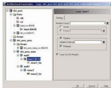
工程师添加结构约束实现循环的展开、合并以及流水管理，映射数组到RAM，控制资源分配等优化硬件的实现
